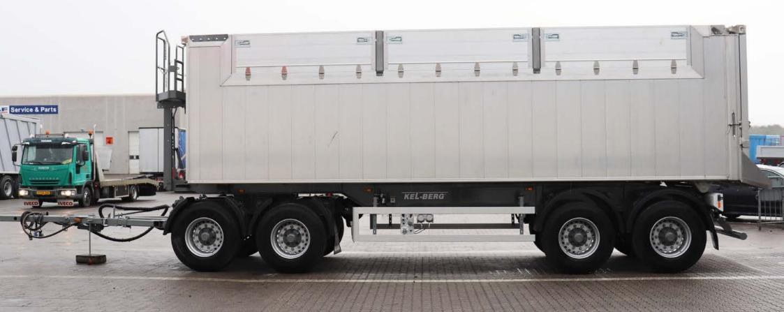
MODEL T560K **KEL-BERG 4-AXLE 34T DRAWBAR TIPPER TRAILER 42 M<sup>3</sup>**
